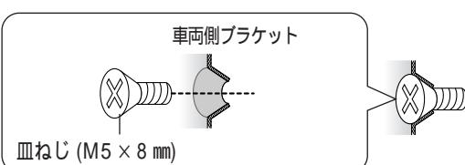
ブラケットが不安定な場合には、スペーサーで取り付けを補強し、固定してください。
