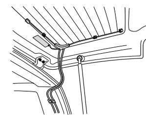
アース板の位置を工夫して貼り付け、ドアの開閉でコードを挟み込まないように、余分なたるみをコードクランパーで押さえてください。
