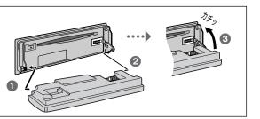
本体とパネルの接点(端子)には触らないで ください。電気的な接触不良を起こす原因に なります。汚れやごみなどがついたときは、 清潔な乾いた布で拭いてください。
