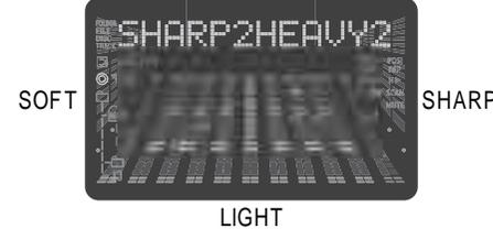
選択されているパターンのポジションが上層で点滅し、イコライザーカーブが下層に表示されます。
