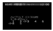
② ボタン で上下の角度 (TILT), <> ボタン で前後の 位置を調整する。(P.23-2 参照)
