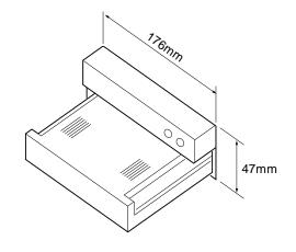
本機の性能を十分に発揮するために,水平に対して 30度以内の角度で取り付けてください。
