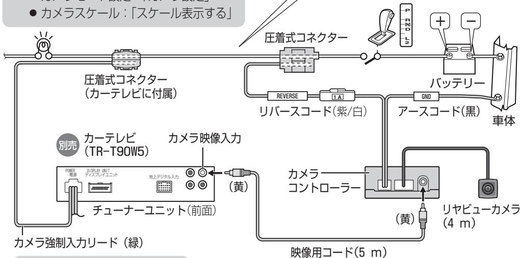
先端の端子を切り離して、圧着式コネクタへ接続してください。
