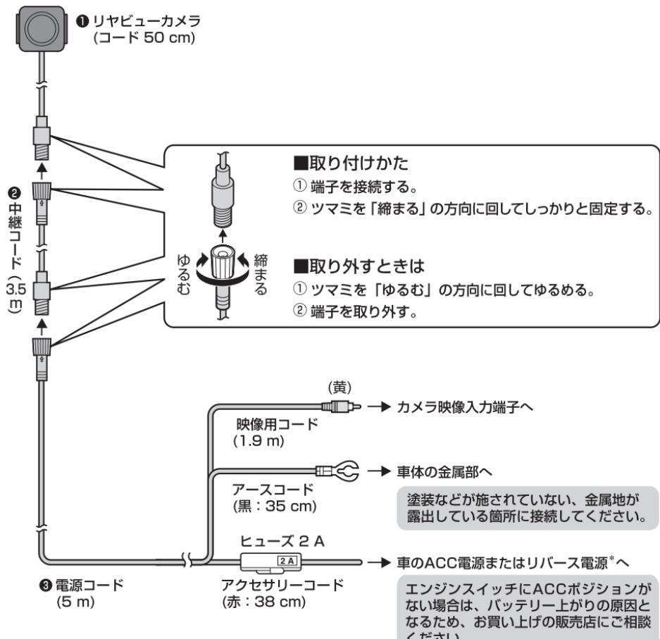
\*車のシフトレバーをリバース(R)に入れたときに点灯するバックランプのプラス線(CY-RC110KDをポータブルカーナビゲーションと接続する場合のみ、リバース電源に接続できます。)
