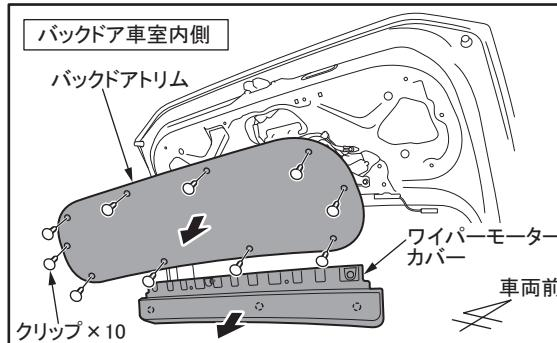
傷付け防止のため、取り外す車両部品の周囲をマスキングテープなどで保護してください。
