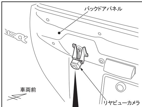
3. バックドアパネルの配線穴にリヤビューカメラのコードを通し、グロメットを取り付ける。
