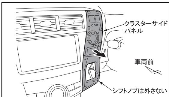
傷付け防止のため、取り外す車両部品の周囲をマスキングテープなどで保護してください。
