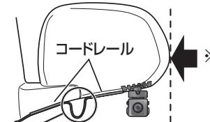
※国土交通省の定める道路運送車両の保安基準に適合させるため、カメラがサイドミラーの端からはみ出ない位置に取り付けてください。
