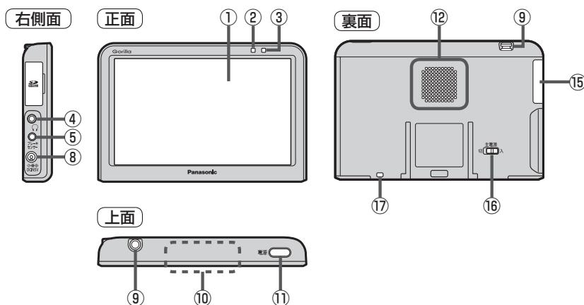
**① タッチパネル部(液晶ディスプレイ)****② 明るさセンサー受光部****③ 充電ランプ**
