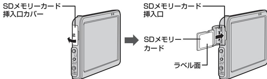
**1** SDメモリーカード挿入口カバーを開け、SDメモリーカードを1回押してから取り出す。
