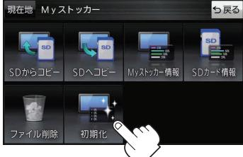
**お願い** 初期化中に本機の電源を切る、本機に接続しているシガーライターコードまたはACアダプターを外す、車のキースイッチをOFFにするなどの行為は絶対に行わないでください。故障の原因となります。
