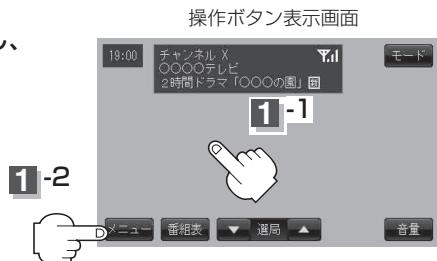
**2** **チャンネル** ボタンをタッチし、リストより呼び出したい放送局をタッチする。
