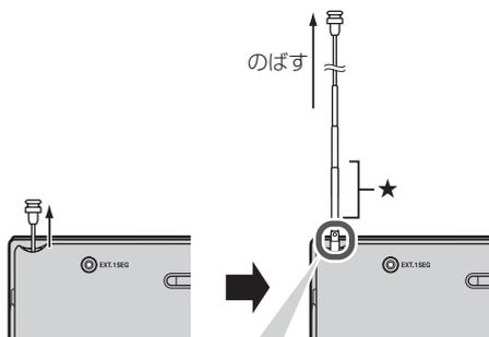
この部分を曲げて方向を調整することができます。方向を調整する場合は、アンテナを全て引き出し、根元付近(★付近)を持って調整してください。アンテナの先端付近を持って調整すると破損するおそれがあります。
