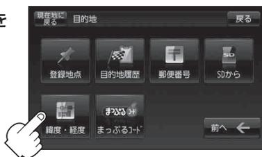
**2** 数字をタッチして、**緯度・経度(日本測地系)**(緯度(北緯)→経度(東経)の順)を入力し、**検索**をタッチする。
