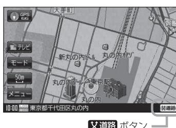
一般道または有料道を走行中に、本機が実際の走行道路と違う道路を走行していた場合に **X道路** をタッチすると強制的に他の道路へと切り換わります。
