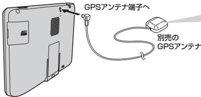
GPSアンテナは車載用としてご使用の場合、ダッシュボードまたは車外(屋根など)に置いて使用します。
