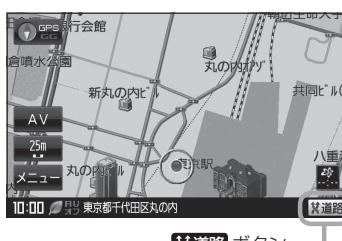
一般道または有料道を走行中に、本機が実際の走行道路と違う道路を走行していた場合に「**X道路**」をタッチすると強制的に他の道路へと切り換わります。
