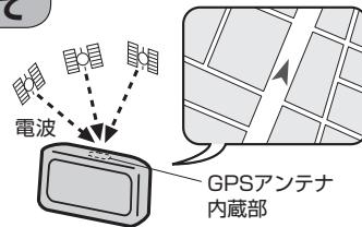
**お知らせ** GPS衛星は、米国の追跡管理センターによって信号をコントロールされているため、意図的に精度が落ちたり、電波が止まってしまうことがあります。
