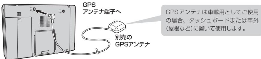
GPSアンテナは車載用としてご使用の場合、ダッシュボードまたは車外(屋根など)に置いて使用します。
