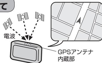
**お知らせ** GPS衛星は、米国の追跡管理センターによって信号をコントロールされているため、意図的に精度が落ちたり、電波が止まってしまうことがあります。
