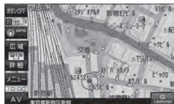
自律航法(Gジャイロ)を搭載し、GPS電波を受信しにくい場所でも、自車位置を高精度に測位します。
