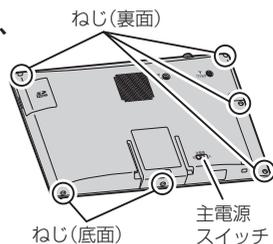
② ドライバー⊖などの工具で、ツメを外しながら、フロントパネルを外す。
