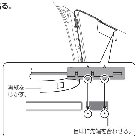
③ アース端子を金属部(塗装面)に貼り付けて、コードを引き回す。
