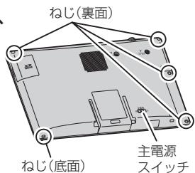
① 本機裏面のねじ(4カ所)と本機底面のねじ(1カ所)を
