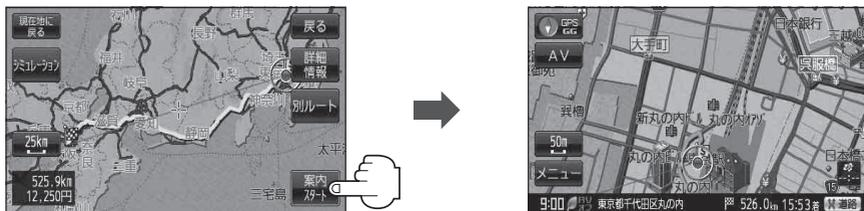
※探索条件を変える場合は、**メニュー** をタッチしてメニュー画面を表示させクイックメニューの **再探索** をタッチし、表示された探索条件の中から選択します。
