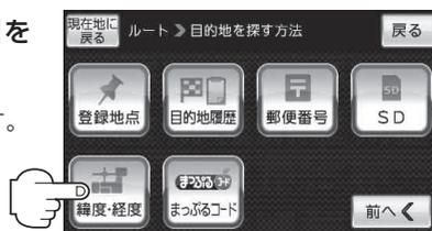
**2** 数字をタッチして、**緯度・経度(日本測地系)**〔緯度(北緯)→経度(東経)の順〕を入力し、**検索**をタッチする。
