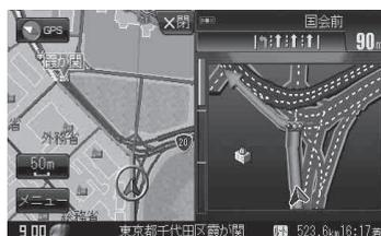
※バーの長さが短くなることによって交差点までの残距離の目安を表します。
