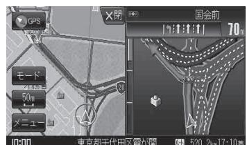
※バーの長さが短くなることによって交差点までの残距離の目安を表します。
