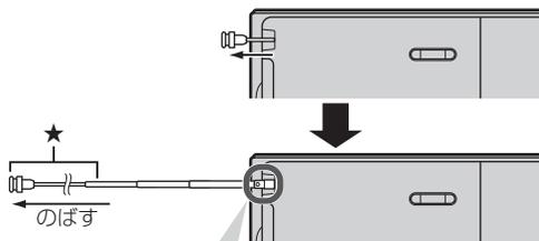
この部分を曲げて方向を調整することができます。方向を調整する場合★部分を持って調整しないでください。破損するおそれがあります。
