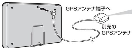
GPSアンテナは車載用としてご使用の場合、ダッシュボードまたは車外(屋根など)に置いて使用します。
