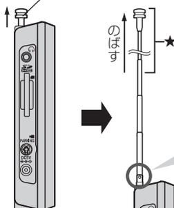
この部分を曲げて方向を調整することができます。方向を調整する場合★部分を持って調整しないでください。破損するおそれがあります。
