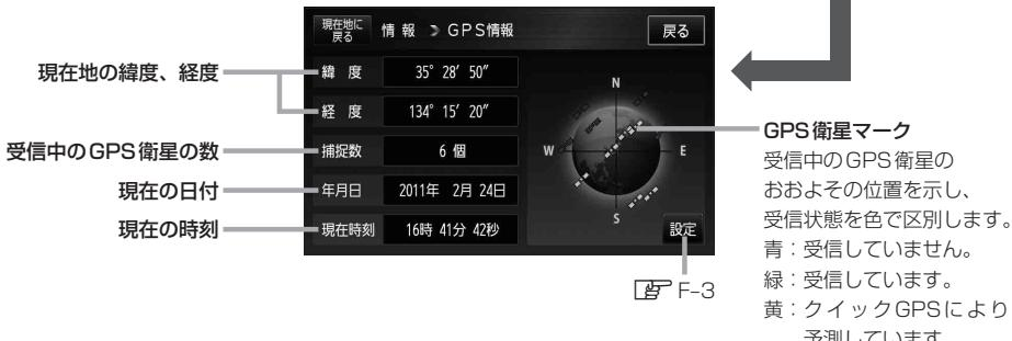
※ GPS衛星の数には、電波を受信できているものその他に、予測データからGPS衛星の位置を推測できているもの、測位に使用できないものも含まれています。
