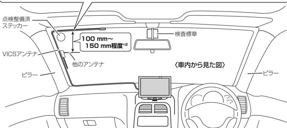
\* 2印…他のアンテナを取り付けている場合、妨害を防ぐため、他のアンテナから100 mm~150 mm程度離して取り付けてください。
