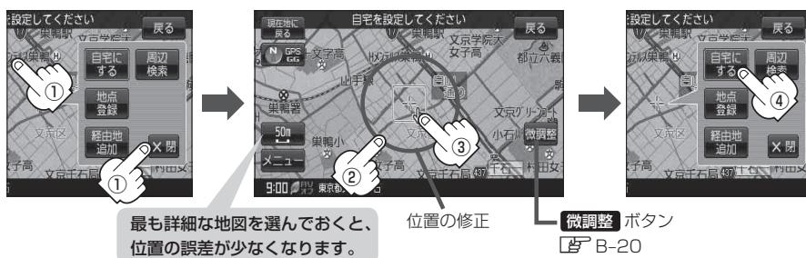
: 地点編集画面に戻ります。登録した位置を確認したい場合は **自宅編集** をタッチし、**地図表示** をタッチすると地図が表示されます。(地図上には マークが表示されます。)
