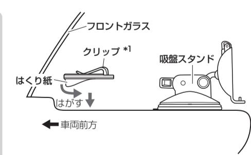
\*1印…クリップは落下防止用ひもを引っ掛ける方をフロントガラス側にして取り付け位置を決めてください。
