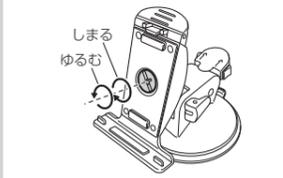
② スタンドアーム固定レバーを起こして、スタンドアームとナビ取付ステーの上下位置を調整し、スタンドアーム固定レバーを倒して固定する。
