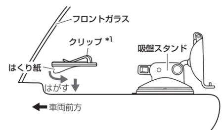
\*1印…クリップは落下防止用ひもを引っ掛ける方をフロントガラス側にして取り付け位置を決めてください。
