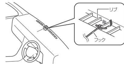
⑤ 吸盤スタンドを取り付け、ジョイントのオス側とメス側を結合する。余ったスタンド用ストラップはコードリールに巻き付けて止め、たるまないように長さを調整する。
