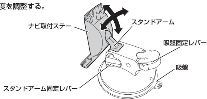
ナビ取付ステーはスタンドアームに対して自由な方向に動かせます。動きが固すぎる／固定具合が弱すぎる場合は、下記のように正面のネジをドライバーまたは工具で調整してください。
