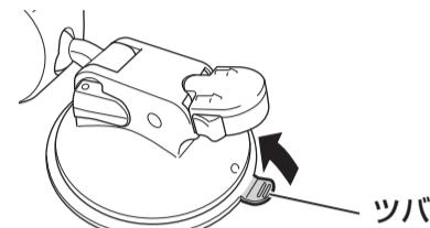
③ 吸盤スタンドを取り外した後、吸盤スタンド保護用シートに貼り付ける。
