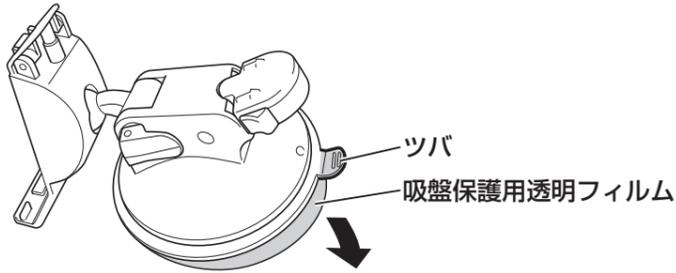
**お願い** すでに吸盤保護用透明フィルムをはがし、吸盤面に吸盤スタンド保護用シートを貼り付けている場合は、吸盤後方のツバ部分を持ち、ゆっくりと吸盤スタンド保護用シートをはがしてください。
