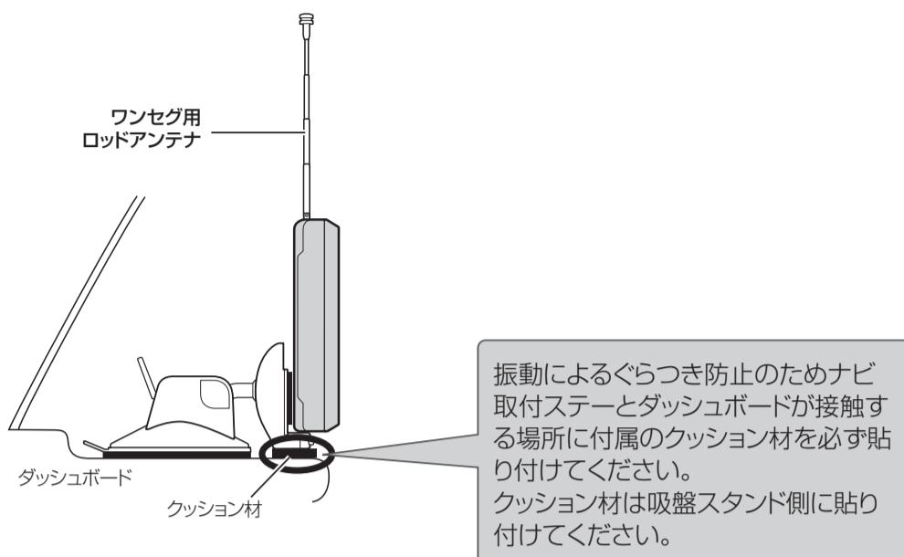
振動によるぐらつき防止のためナビ取付ステーとダッシュボードが接触する場所に付属のクッション材を必ず貼り付けてください。
