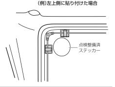
3 VICSアンテナの先端近くにコードクランパーを取り付け、はくり紙をはがし、貼り付ける。
