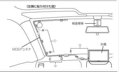
5 VICSアンテナケーブル端子を本機側面の VICSアンテナ端子へ接続する。
