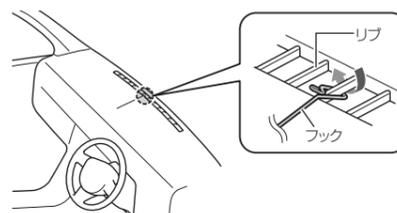
⑤ 吸盤スタンドを取り付け、ジョイントのオス側とメス側を結合する。余ったスタンド用ストラップはコードリールに巻き付けて止め、たるまないように長さを調整する。
