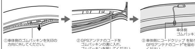
※印…国土交通省の定める保安基準※に適合させるため、コードクランパーは車内に取り付けてください。
