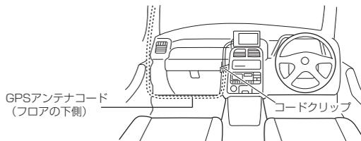
※ドアのゴムパッキン部にアンテナコードを通し、車外に引き出してください。
