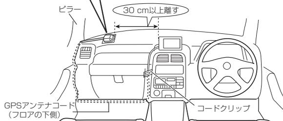
※GPSアンテナ取付板を使用せず、GPSアンテナだけでのご使用は、おやめください。受信感度が極端に悪化します。(車外に取り付けられる場合は、GPSアンテナ取付板は不要です。)
