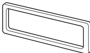
2DIN タイプの車でパネルの下側が当たる場合は、右図のようにパネルの下側をカットしてください。
