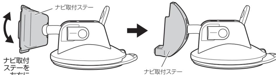
② スタンドアーム固定レバーを起こして、スタンドアームとナビ取付ステーの上下位置を調整し、スタンドアーム固定レバーを倒して固定する。
