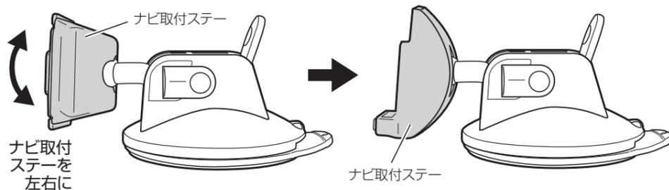
② スタンドアーム固定レバーを起こして、スタンドアームとナビ取付ステーの上下位置を調整し、スタンドアーム固定レバーを倒して固定する。
