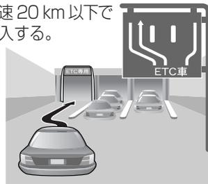
**7** ETC車載器と路側アンテナの間で、料金の精算に必要な情報が通信されます。
