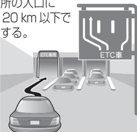
ETC車載器と路側アンテナの間で、通過するために必要な情報が通信されます。
