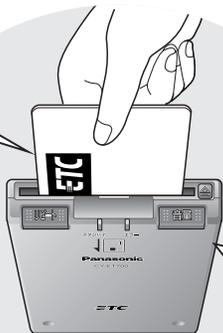
セットアップの完了したETC車載器に正しく差し込めば準備完了です。
